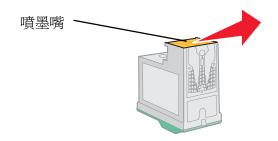
d 利用布上另外的乾淨區域,輕輕將清潔用布靠在接點上約三秒鐘,然後依顯示的方向擦拭。
