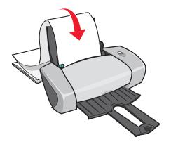
3 緊靠著紙張托架的右側,將長條海報紙的前緣載入印表機。
